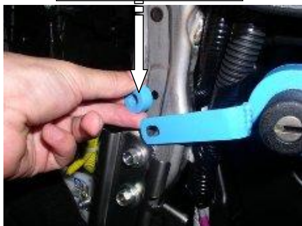
Установить замок, подложив под лапку столбик 10 мм.
