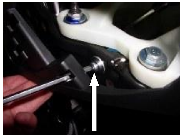
Зафиксировать защиту тяг срывным болтом
