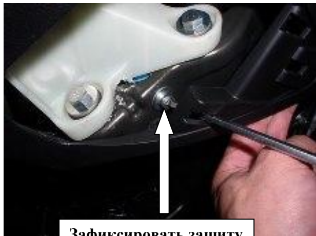
Зафиксировать защиту тяг срывным болтом
