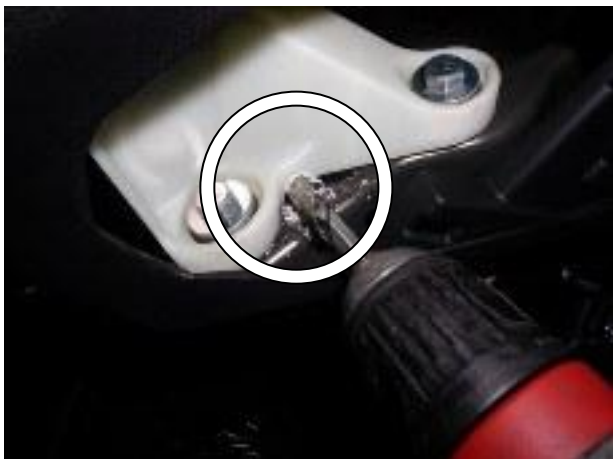
Удалить пластик селектора, мешающий установке защиты
