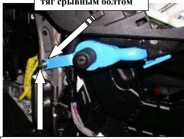
Зафиксировать лапку замка срывным болтом и несрывной гайкой с обратной стороны стойки селектора
