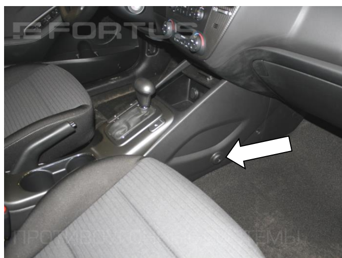
16. Проверьте работоспособность замка, сорвите крепеж, соберите консоль
