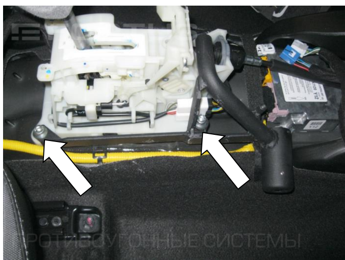
11. Установите замок (поз. 1), закрепив с помощью болтов (поз. 7, 8) с шайбами (поз. 10)
