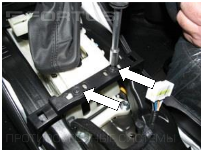
3. Снимите рукоятку рычага КПП
