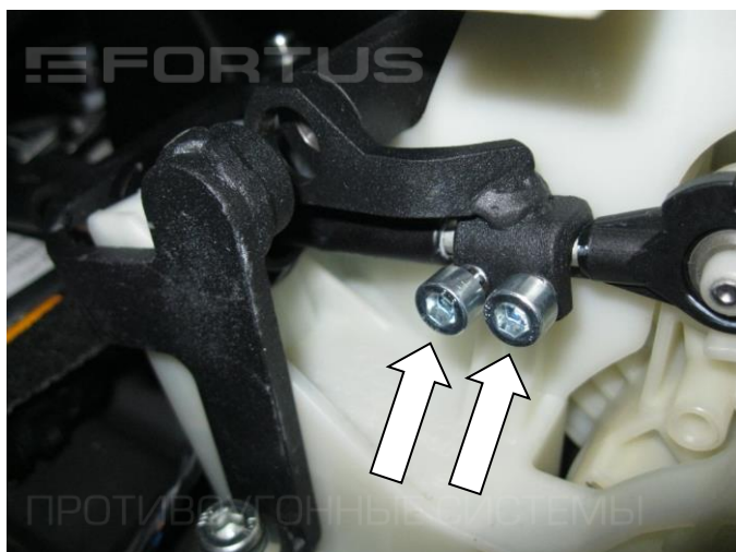
13. Установите прихват (поз. 2), закрепив с помощью болтов (поз. 5)
