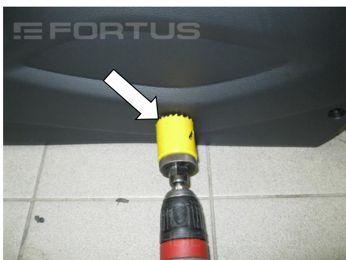
15. Разметьте и просверлите отверстие под корпус замка \varnothing 32 мм
