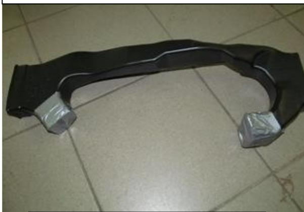
Удалить часть воздуховода, замотать концы изолентой, вернуть воздуховод на место
