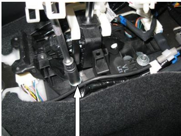
Открутить штатный болт селектора
