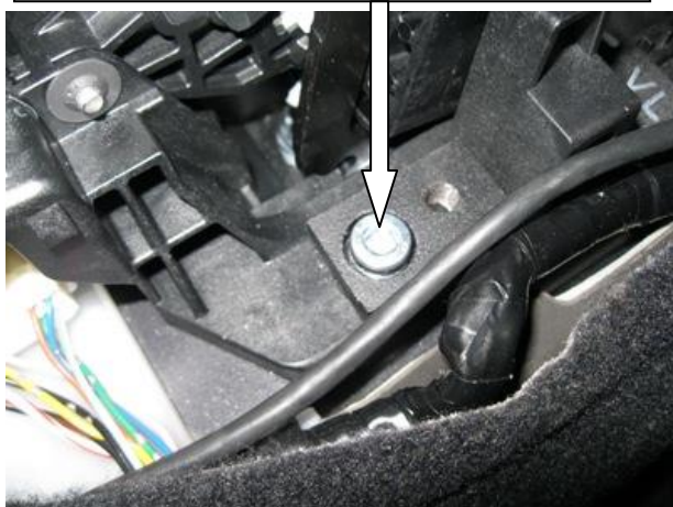
Закрутить срывной болт
