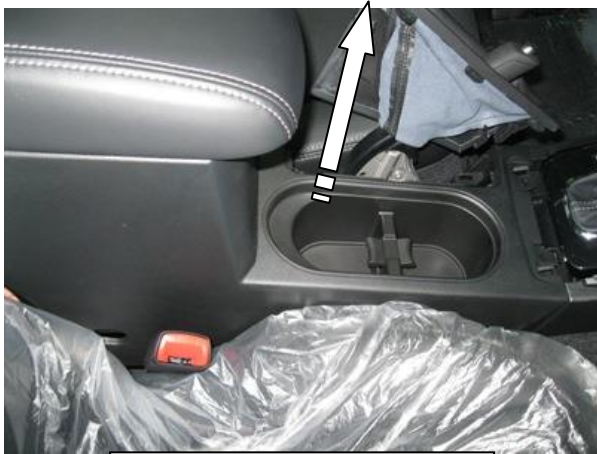
Снять заднюю консоль
