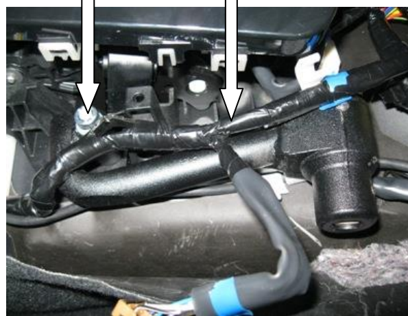
Установить замок на пластину-переходник, закрутить 2 срывных болта
