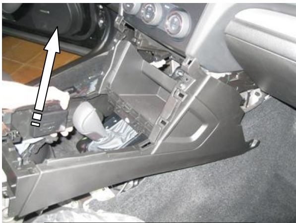
Снять переднюю консоль
