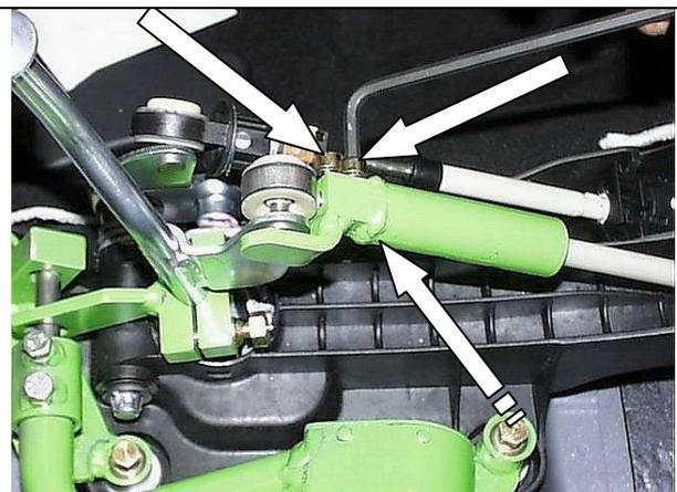
Установить защиту тяги на тягу, зафиксировать 2 винтами
