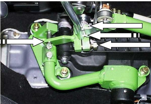
Установить хомут и ответную часть на рычаг переключения передач, перевести рычаг в положение «R», произвести блокировку, отрегулировать положение хомута на рычаге, зафиксировать хомут 2 срывными болтами
