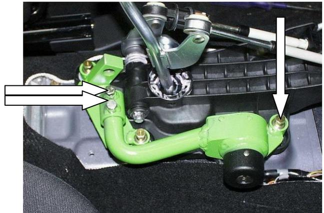
Установить замок, зафиксировать трубу замка в кольце кронштейна замка 2 винтами, зафиксировать лапку замка срывным болтом
