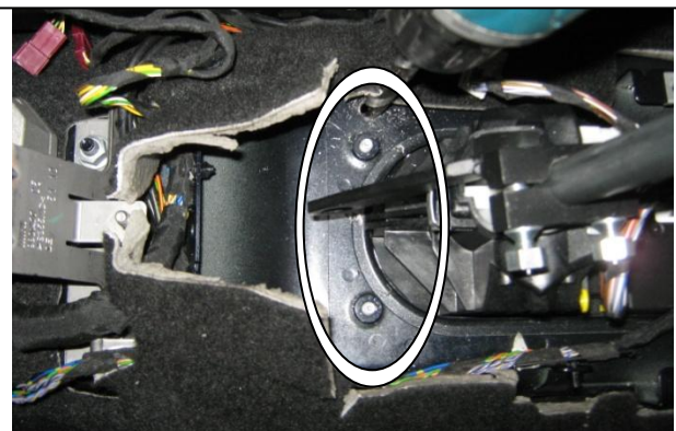
21 Просверлить 2 крепёжных отверстия 9 мм., установить в них резьбовые заклёпки с помощью клёпальника
