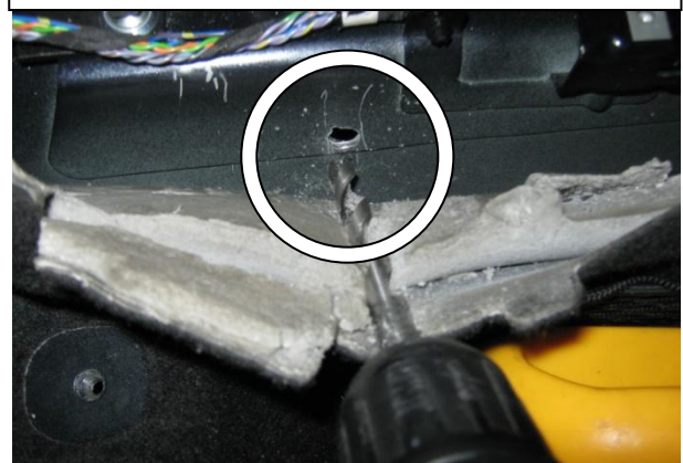
23 Наметить точки сверления крепёжных отверстий сквозь отверстия в лапке замка, открутить винты, снять замок, просверлить 2 крепёжных отверстия 9 мм.
