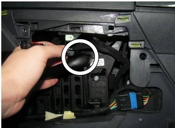
Установить замок на столбики, разметить точку сверления селектора по трубе замка
