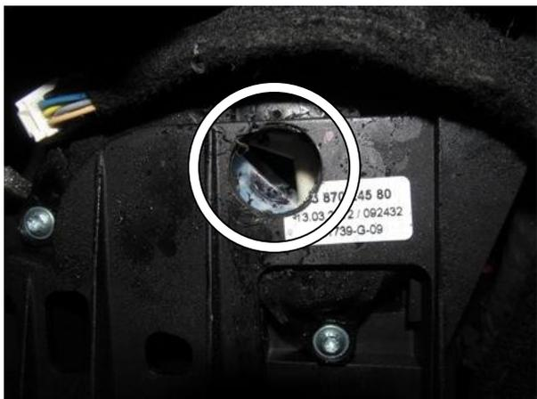
Разметить место фрезеровки выемки под ригель замка
