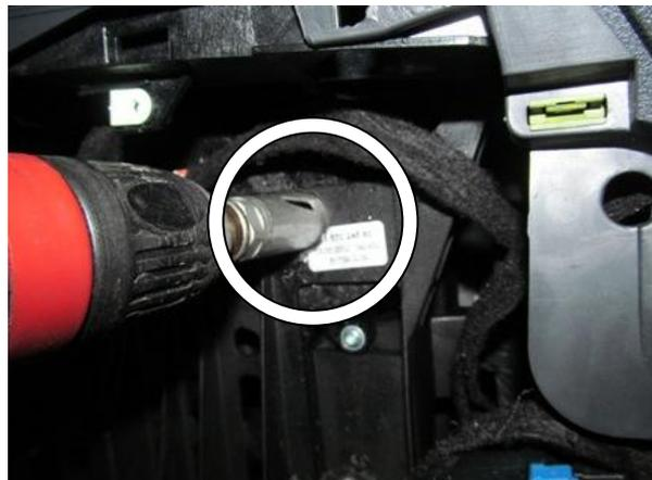
Снять замок, просверлить отверстие в стенке селектора под трубу замка
