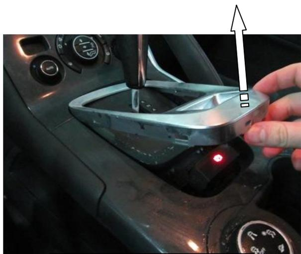
Снять верхнюю крышку
