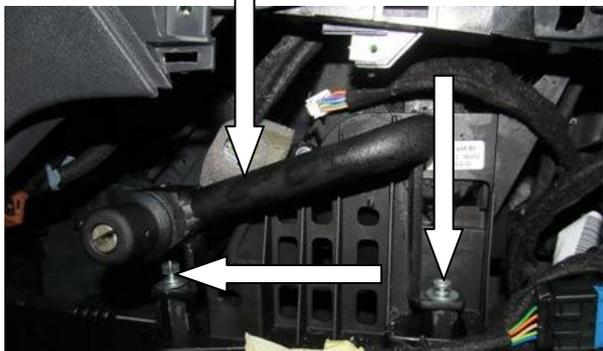
Установить замок на столбики трубой в отверстие, зафиксировать 3 срывными болтами, перевести рычаг переключения передач в положение «Р», произвести и проверить блокировку
