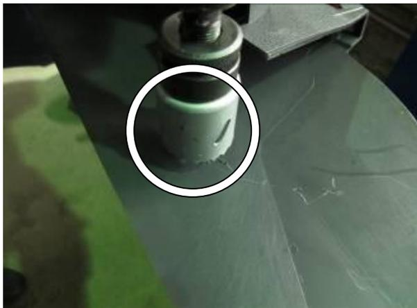
Просверлить и расширить отверстие
