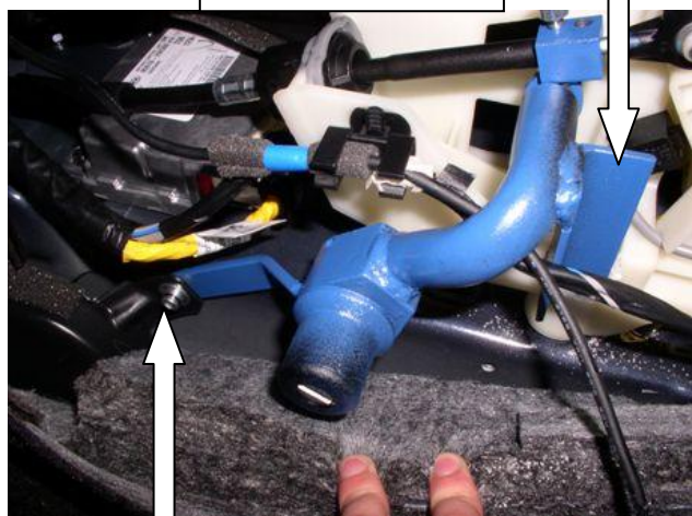
Установить замок, закрутить 2 срывных болта
