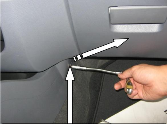
Снять заглушку, открутить саморез
