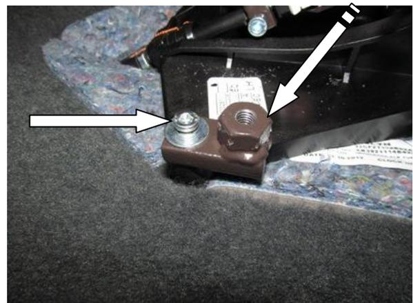
Установить пластину-переходник, закрутить срывной болт
