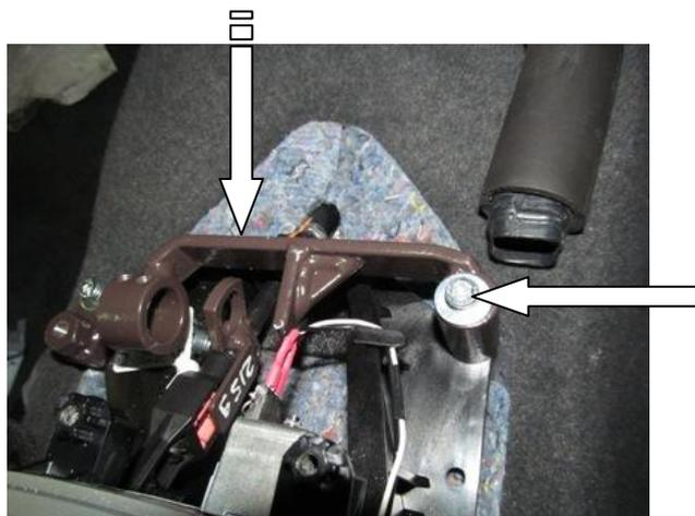
Установить кронштейн замка, закрутить срывной болт
