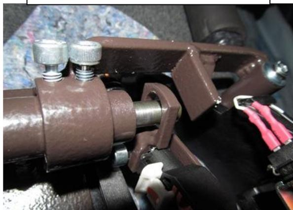
Перевести рычаг переключения передач в положение «Р», произвести и проверить блокировку хомута
