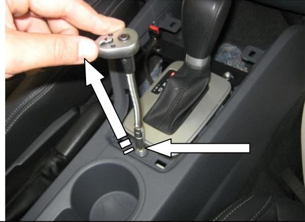
Снять декоративную панель, открутить саморез
