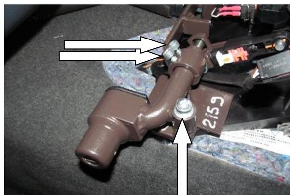
Установить замок на пластину-переходник трубой в кольцо кронштейна, закрутить срывной болт, зафиксировать трубу 2 винтами
