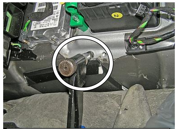
Установить резьбовые заклёпки в отверстия с помощью клёпальника
