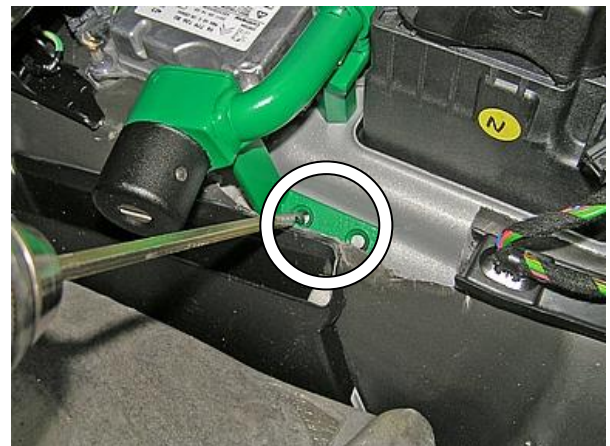
Просверлить крепёжные отверстия в днище сквозь отверстия в лапке замка
