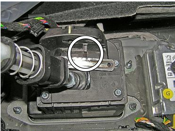
Удалить мешающий пластик селектора
