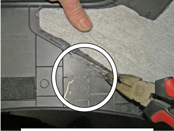
Удалить мешающие рёбра жёсткости боковой крышки
