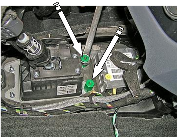
Установить шестигранные столбики на шпильки
