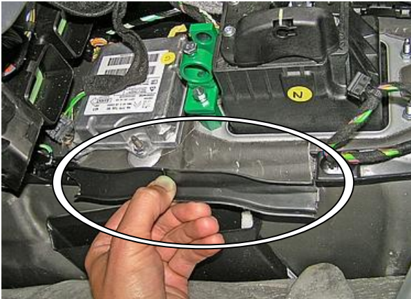
Удалить мешающий пластик селектора
