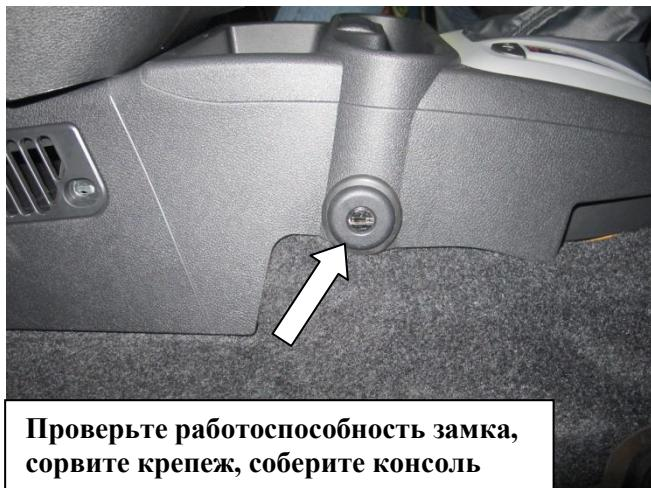
**Проверьте работоспособность замка,
