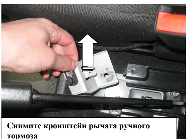
Снимите кронштейн рычага ручного тормоза
