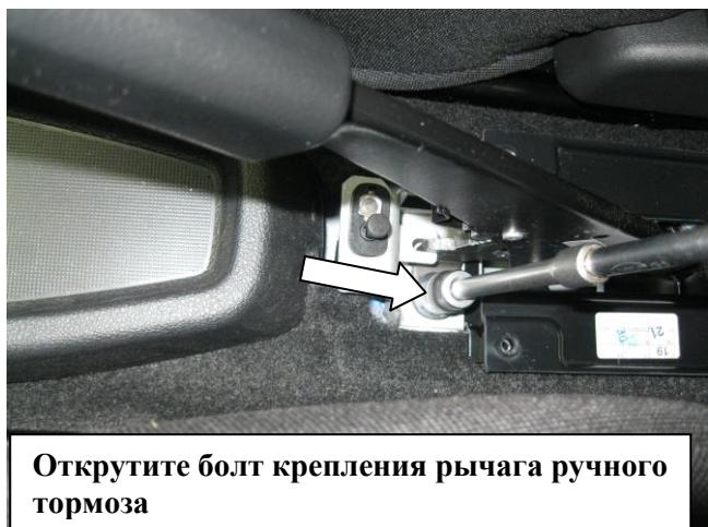
Открутите болт крепления рычага ручного тормоза
