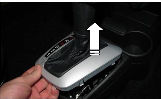
Отсоедините чехол рычага переключения передач КПП
