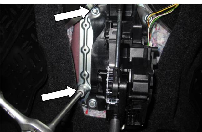
Открутите две гайки крепления селектора
