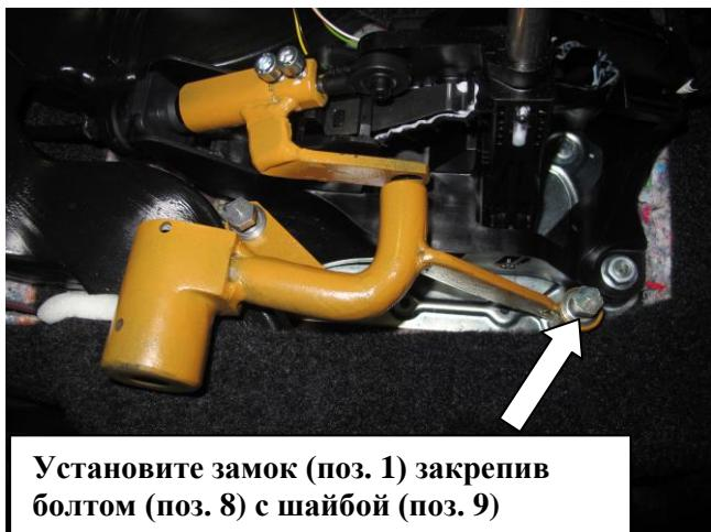
Установите замок (поз. 1) закрепив
