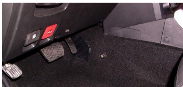
Разметить отверстие под цилиндр замка, используя разметочный шаблон, просверлить отверстие в ковровине, установить ковролин на место
