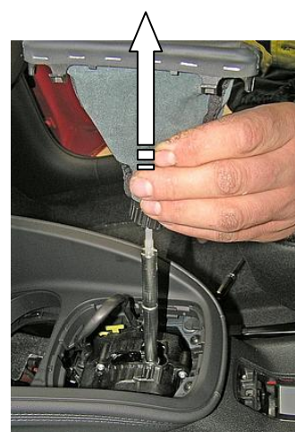
Снять рукоятку рычага переключения передач
