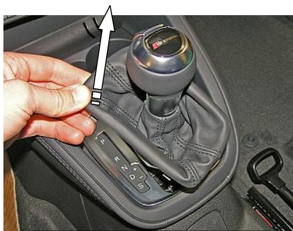
Снять декоративный чехол рычага переключения передач
