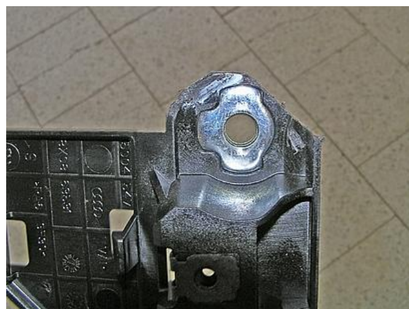
Удалить мешающую установке замка часть держателя консоли
