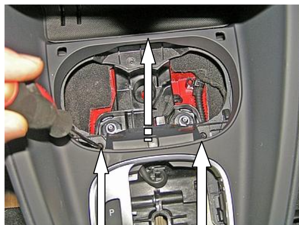
Открутить 2 самореза, снять консоль
