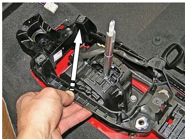
Снять держатель консоли
