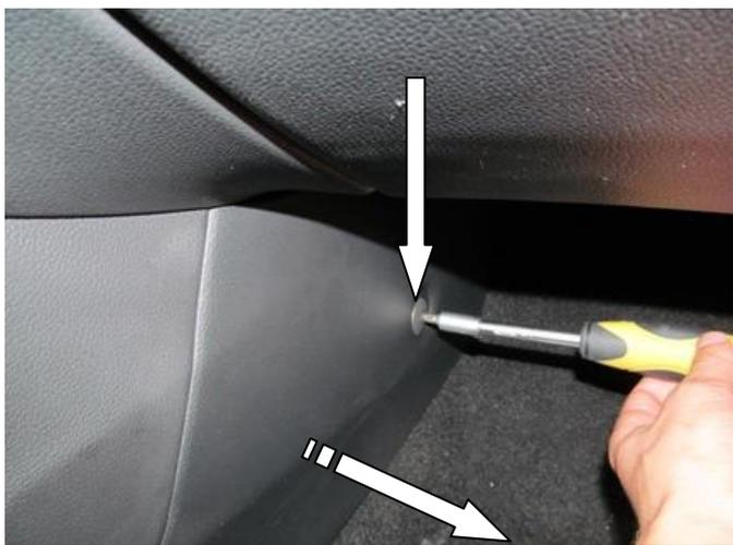
Открутить саморез, снять боковую крышку
