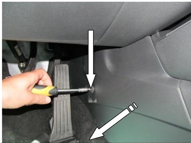
Открутить саморез, снять боковую крышку
