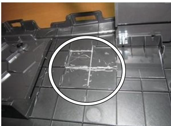
**Удалить мешающие рёбра жёсткости, разметить, используя разметочный шаблон, отверстие в консоли под корпус замка**
