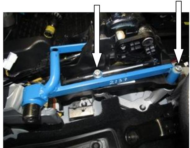
Установить замок на селектор, зафиксировать с срывными болтами
