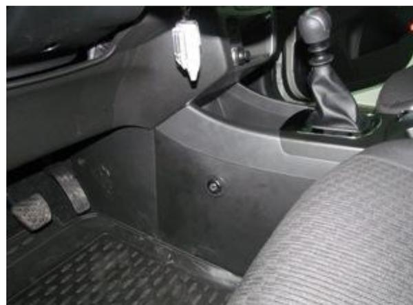
**Просверлить и расширить до 32 мм. отверстие, собрать консоль**
