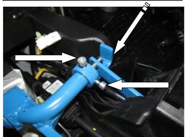
Установить защиту ригеля на трубу замка, зафиксировать 2 винтами
