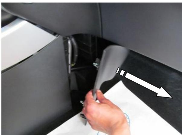
Снять боковую крышку
