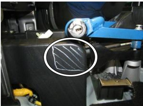
Удалить мешающую установке замка часть воздуховода, заклеить отверстие скотчем
