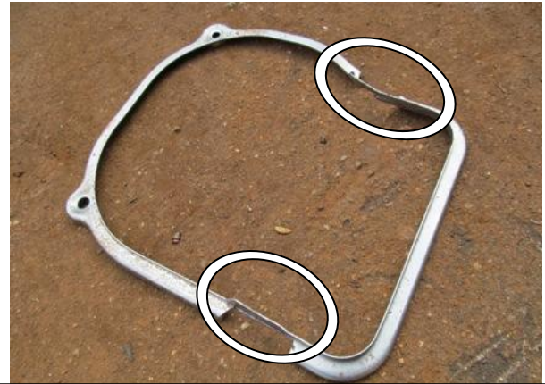
Снять рамку звукоизоляционного кожуха, удалить мешающий установке замка металл
