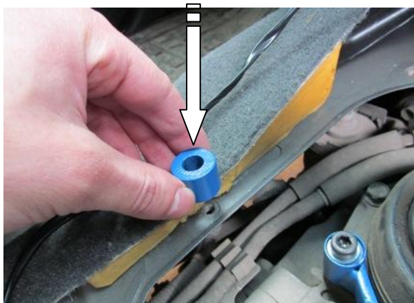
Открутить 4 болта, установить столбик 15 мм.
