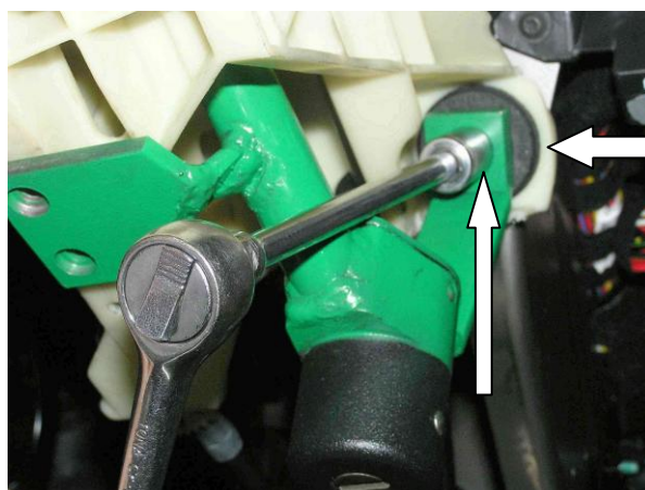
Установить замок, подложив шайбу под лапку, закрутить болт
