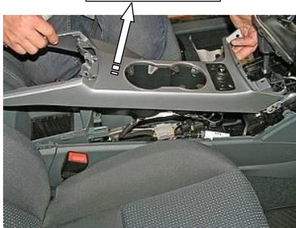
Снять верхнюю крышку
