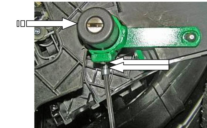
Установить прямоходный цилиндр в кронштейн замка, зафиксировать 2 винтами
