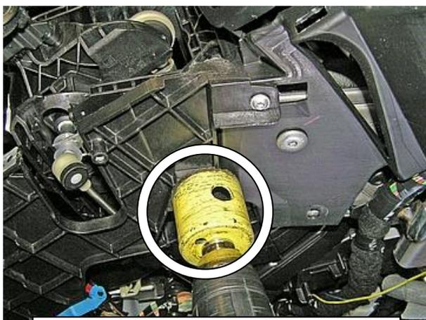
**Просверлить отверстие 42 мм. в
