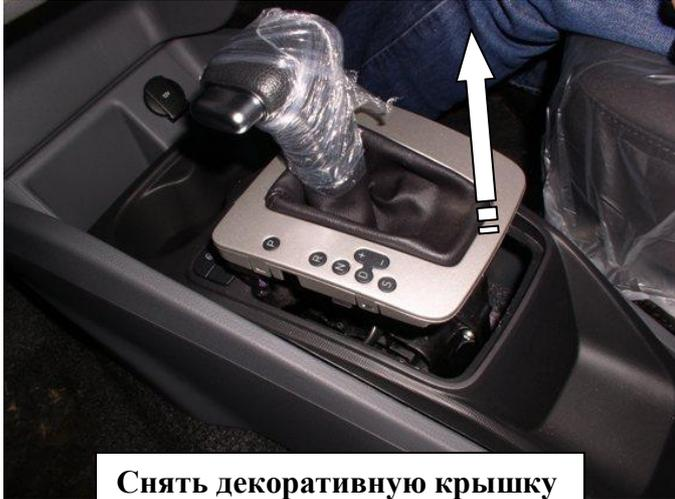
Снять декоративную крышку
