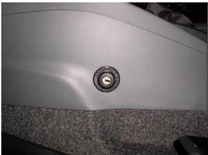
Разметить, используя разметочный шаблон, и просверлить отверстие в консоли, установить консоль на место
