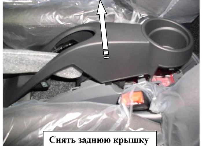
Снять заднюю крышку
