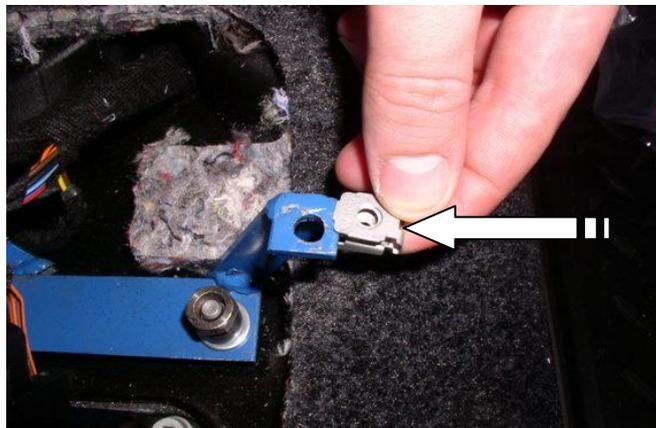
Установить фиксаторы на держатель консоли
