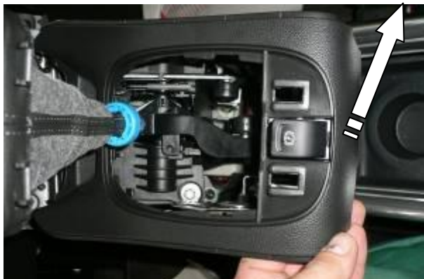
Снять верхнюю крышку, снять консоль
