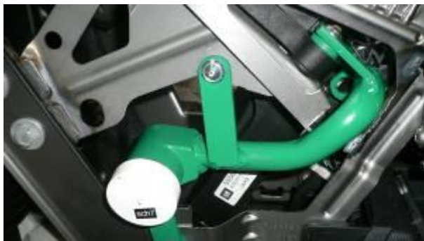
Разметить, используя разметочный шаблон, отверстие в консоли под корпус замка
