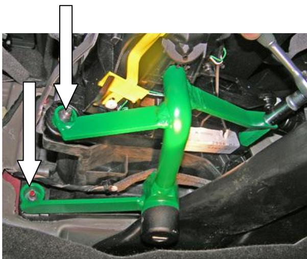
Разметить отверстие в консоли при помощи шаблона
