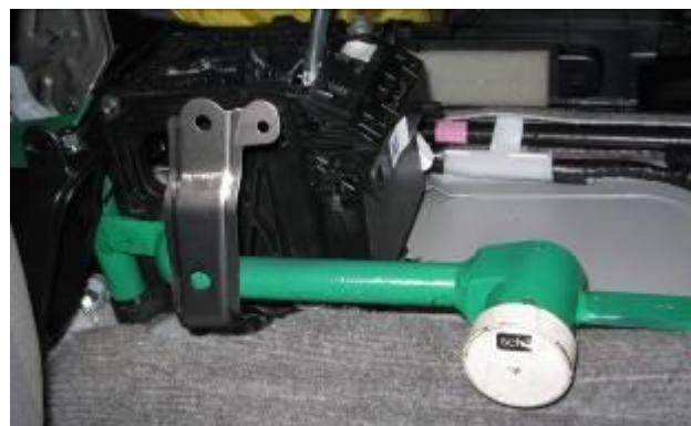
Разметить, используя разметочный шаблон, и просверлить отверстие в консоли под корпус замка
