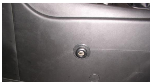
Разметить, используя разметочный шаблон, и просверлить отверстие в консоли под корпус замка, установить консоль на место
