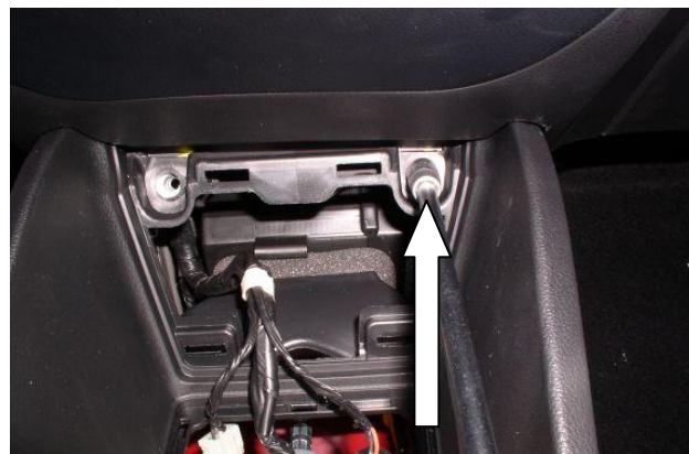
Открутите винт крепления консоли
