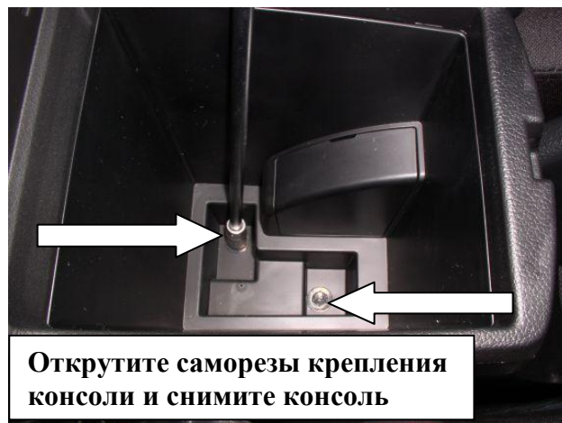
Открутите винт крепления консоли
