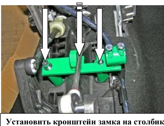
Установить замок, зафиксировать болтом лапку замка
