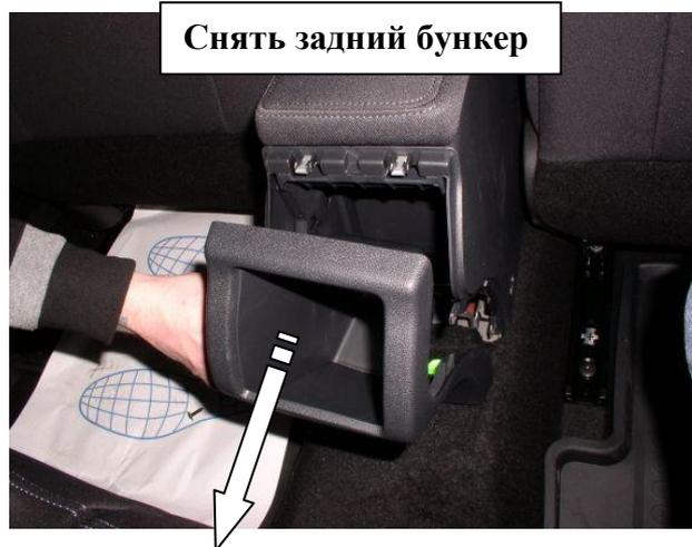
Снять задний бункер
