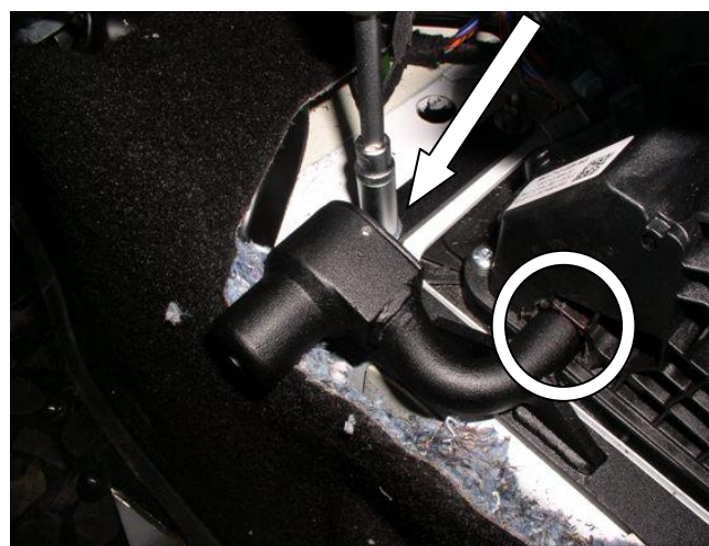
Открутить 3 гайки, просверлить отверстие в селекторе под трубу замка, установить замок, закрутить гайку
