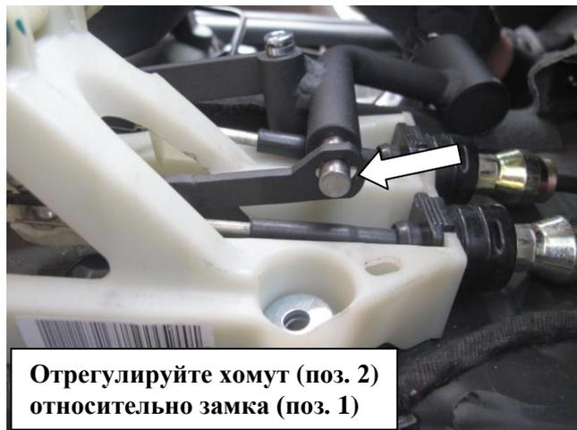
Отрегулируйте хомут (поз. 2) относительно замка (поз. 1)
