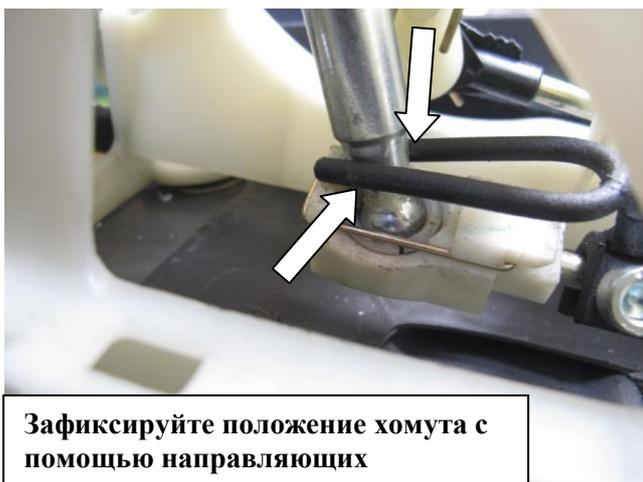
Зафиксируйте положение хомута с помощью направляющих
