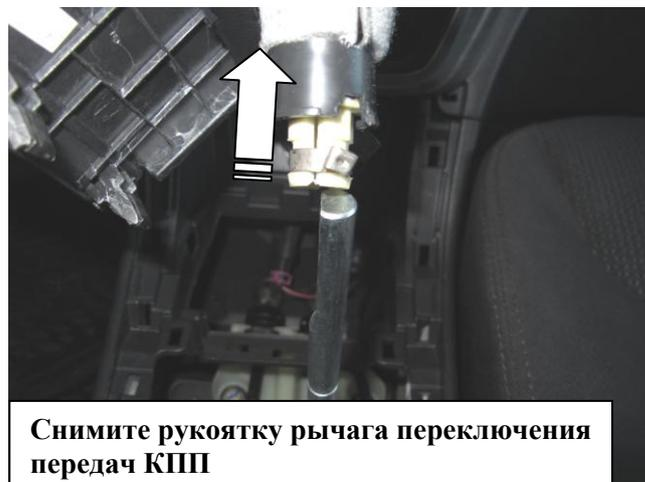
Снимите рукоятку рычага переключения передач КПП
