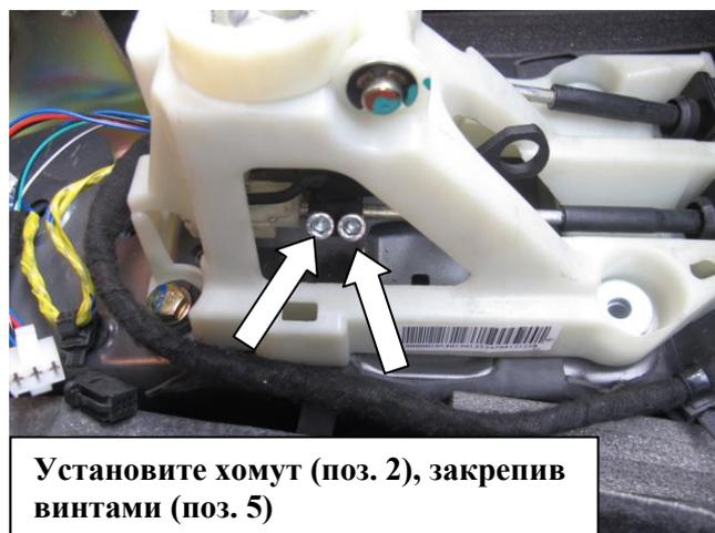
Установите хомут (поз. 2), закрепив винтами (поз. 5)
