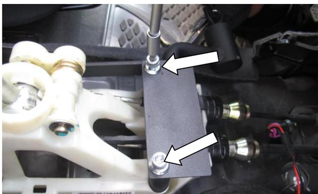
Установите защиту (поз. 3), закрепив болтами (поз. 7) с шайбами (поз. 8)
