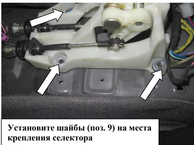
Установите шайбы (поз. 9) на места крепления селектора
