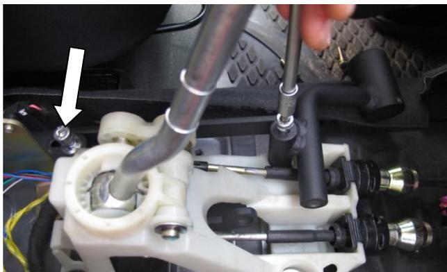
Установите замок (поз. 1) закрепив заднюю точку болтом (поз. 6) с шайбой (поз. 8)
