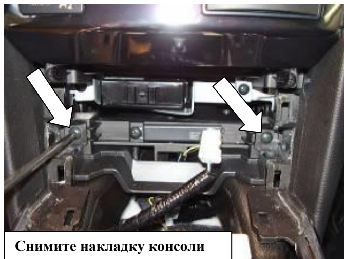
Открутите винт крепления консоли с обеих сторон
