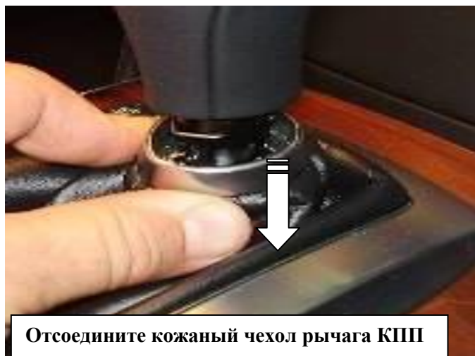
Извлеките стопорную скобу. Снимите рукоятку рычага КПП
