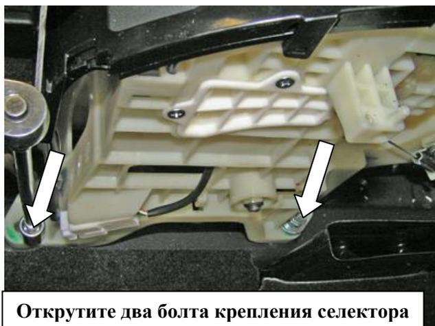
Открутите два болта крепления селектора
