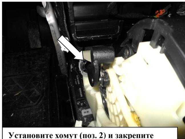
Установите хомут (поз. 2) и закрепите болтом (поз. 3)
