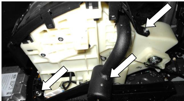
Установите замок (поз. 1) и закрепите болтами (поз.5) с шайбами (поз. 7) и болтом (поз. 4) с гайкой (поз. 6) предварительно просверлив отверстие ф 7мм в стенке селектора
