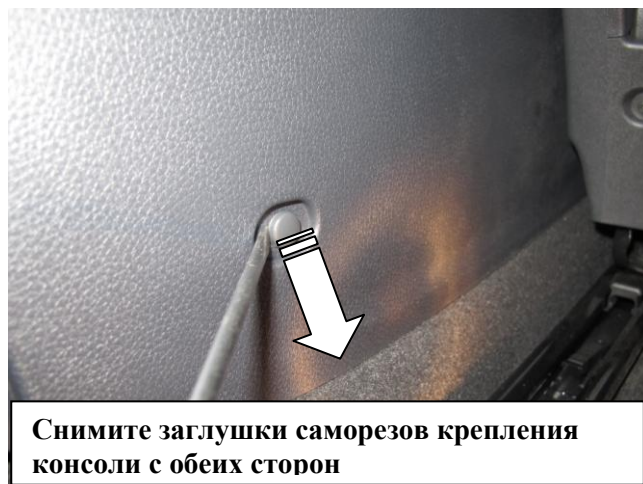
Открутите саморезы крепления консоли
