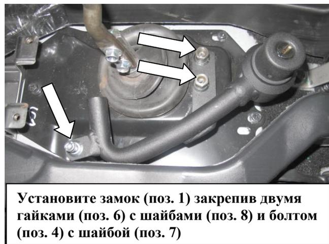
Установите замок (поз. 1) закрепив двумя гайками (поз. 6) с шайбами (поз. 8) и болтом (поз. 4) с шайбой (поз. 7)
