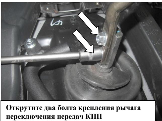
Открутите два болта крепления рычага переключения передач КПП
