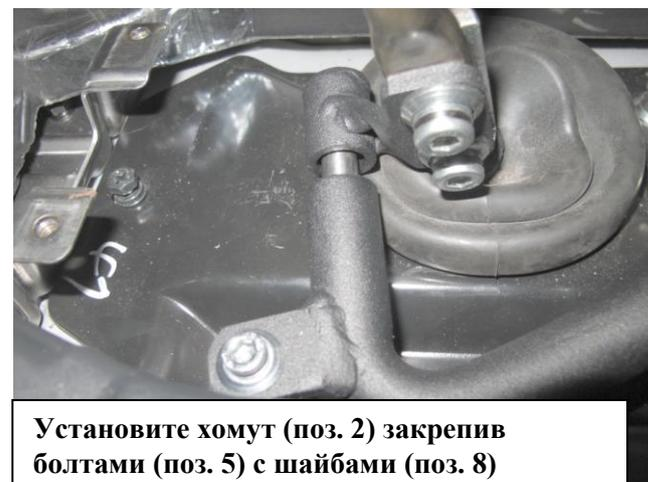
Установите хомут (поз. 2) закрепив болтами (поз. 5) с шайбами (поз. 8)
