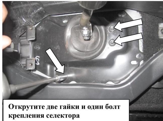
Открутите две гайки и один болт крепления селектора
