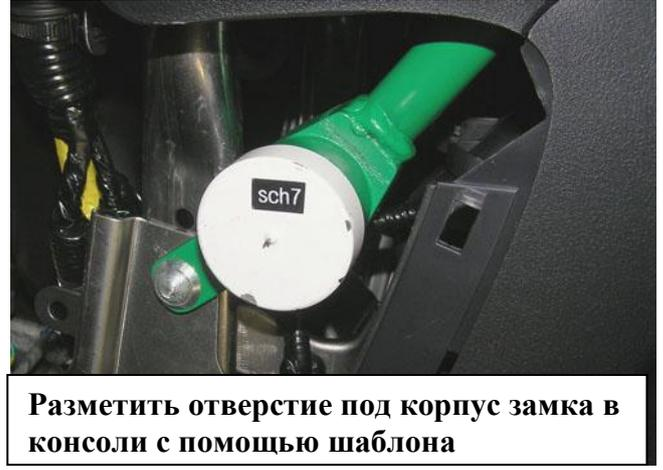
Разметить отверстие под корпус замка в консоли с помощью шаблона
