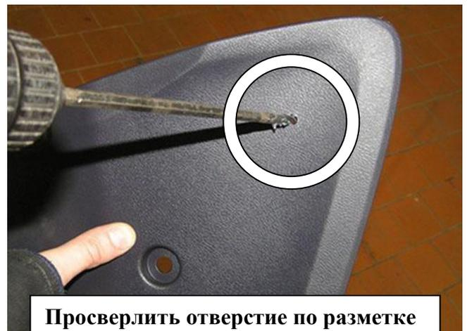
Просверлить отверстие по разметке
