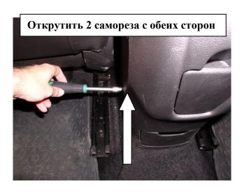
Снять декоративную крышку
