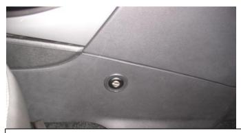
Разметить, используя разметочный шаблон, и просверлить в крышке отверстие под корпус замка, установить крышку на место
