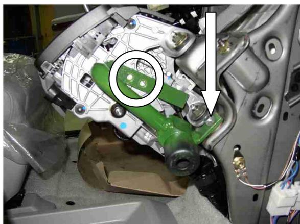
Просверлить крепёжные отверстия в селекторе, используя лапку замка как шаблон
