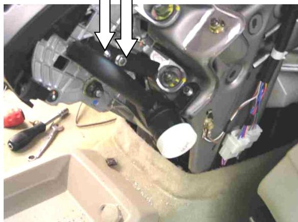
Зафиксировать замок на селекторе с помощью срывного болта и несрывных гаек, разметить, используя разметочный шаблон, и просверлить отверстие в консоли под корпус замка
