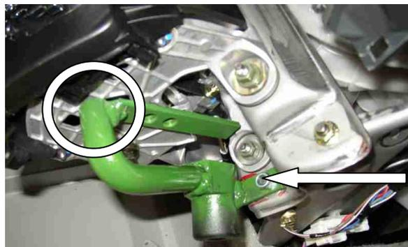
Открутить штатную гайку селектора, установить замок на шпильку, зафиксировать срывной гайкой, разметить и просверлить отверстие в селекторе под трубу замка
