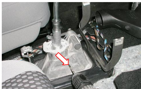
Просверлить отверстие в селекторе
