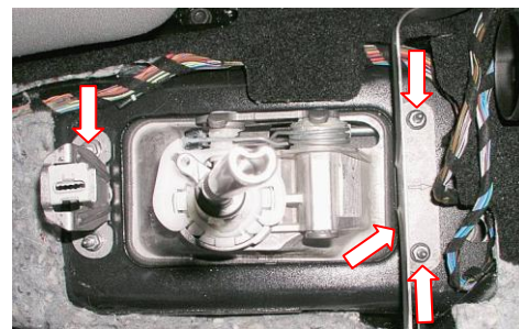
Открутить 3 болта, снять деталь
