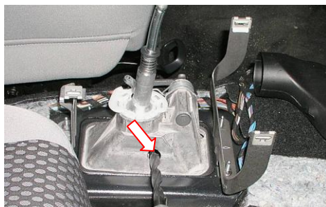
Расширить отверстие в селекторе
