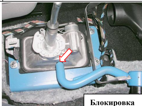
Расширить отверстие в селекторе
