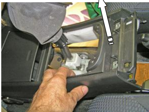
Снять переднюю консоль
