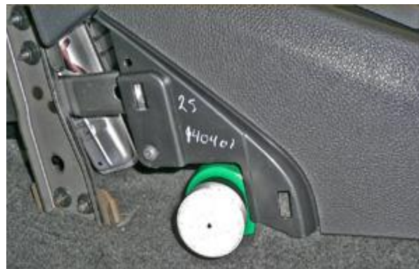
Собрать консоль, разметить, используя разметочный шаблон, отверстие в боковой крышке под корпус замка
