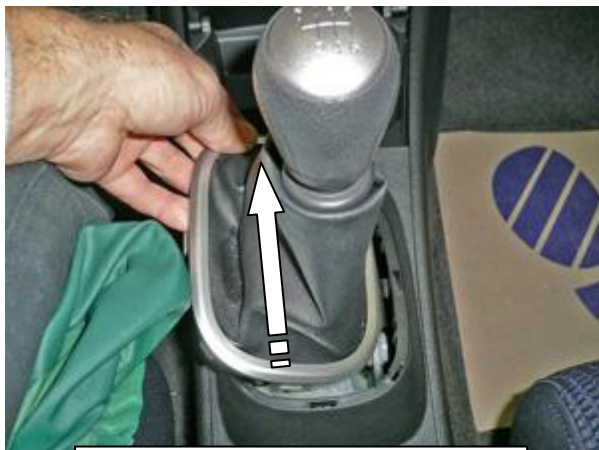
Снять декоративный кожух
