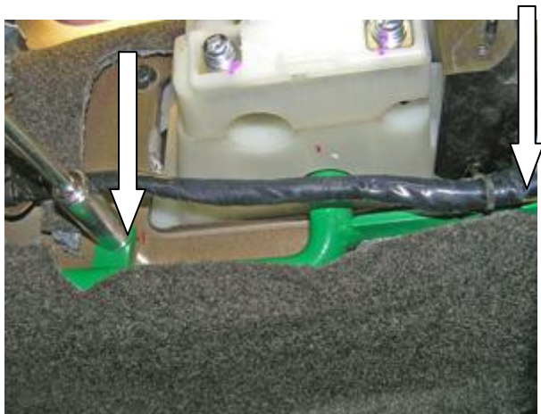
Установить замок, закрутить 2 болта
