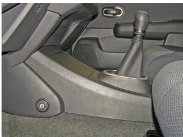
Установить боковую крышку на место
