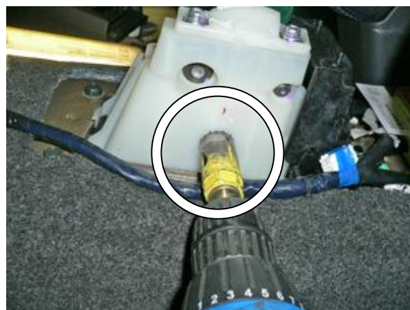
Просверлить отверстие в селекторе под трубу замка
