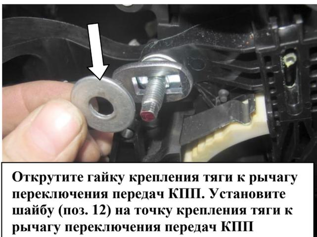
Открутите гайку крепления тяги к рычагу переключения передач КПП. Установите шайбу (поз. 12) на точку крепления тяги к рычагу переключения передач КПП
