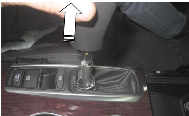
Снимите рукоятку рычага переключения передач КПП
