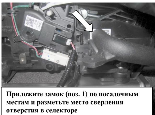
Приложите замок (поз. 1) по посадочным местам и разметьте место сверления отверстия в селекторе
