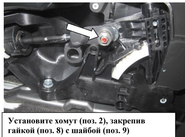
Установите хомут (поз. 2), закрепив гайкой (поз. 8) с шайбой (поз. 9)
