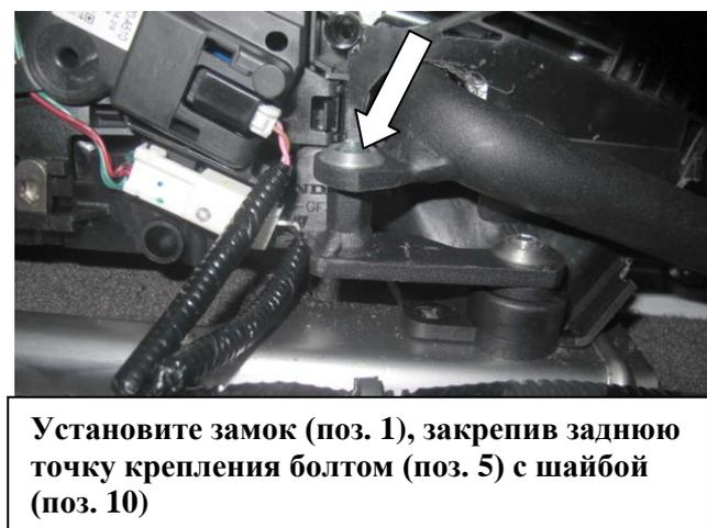
Установите замок (поз. 1), закрепив заднюю точку крепления болтом (поз. 5) с шайбой (поз. 10)
