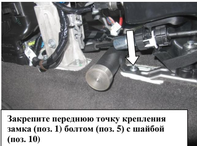
Закрепите переднюю точку крепления замка (поз. 1) болтом (поз. 5) с шайбой (поз. 10)
