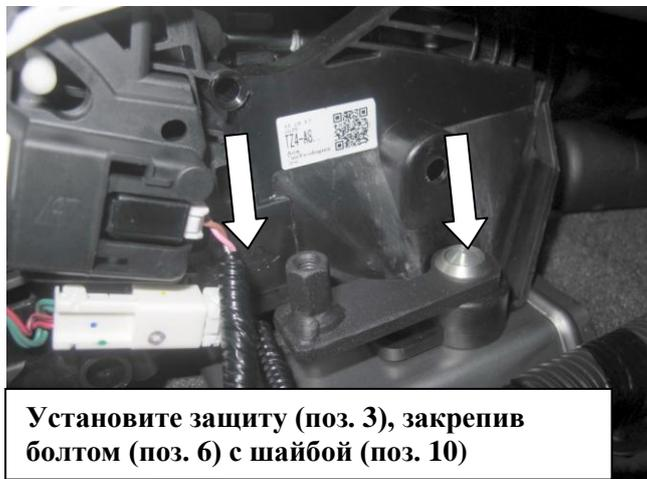
Установите защиту (поз. 3), закрепив болтом (поз. 6) с шайбой (поз. 10)
