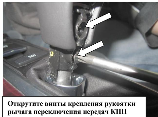
Открутите винты крепления рукоятки рычага переключения передач КПП
