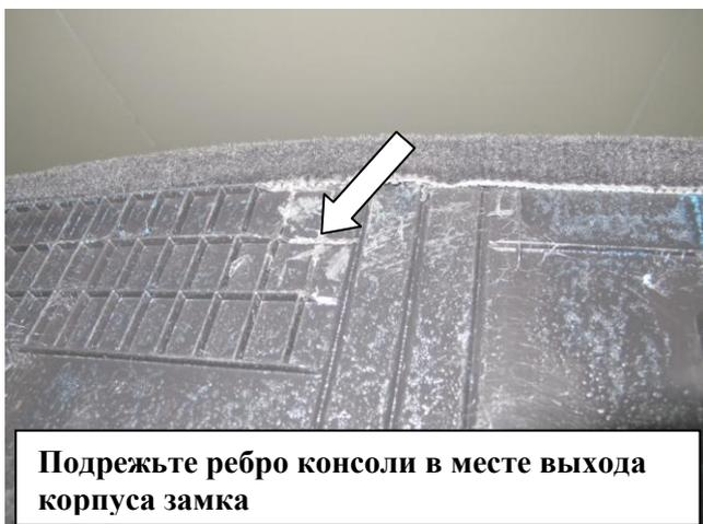
Подрежьте ребро консоли в месте выхода корпуса замка
