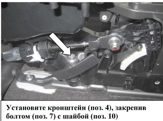
Установите кронштейн (поз. 4), закрепив болтом (поз. 7) с шайбой (поз. 10)
