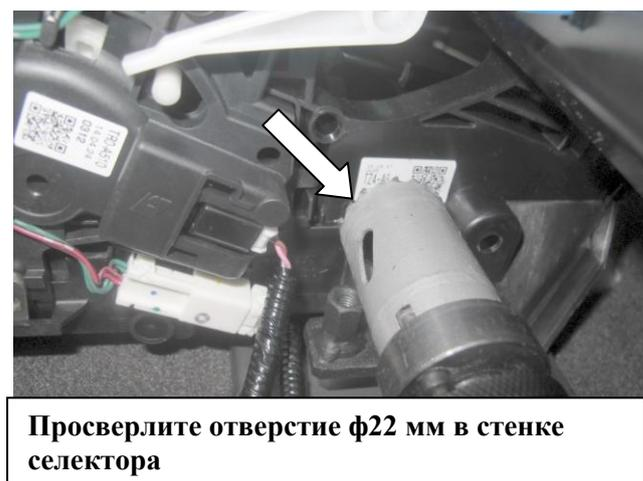
Просверлите отверстие  $\varnothing 22$  мм в стенке селектора
