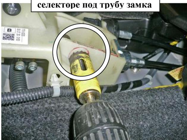
Расширить отверстие до 22 мм.
