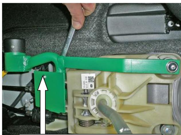
Закрутить срывной болт, зафиксировав защиту на замке
