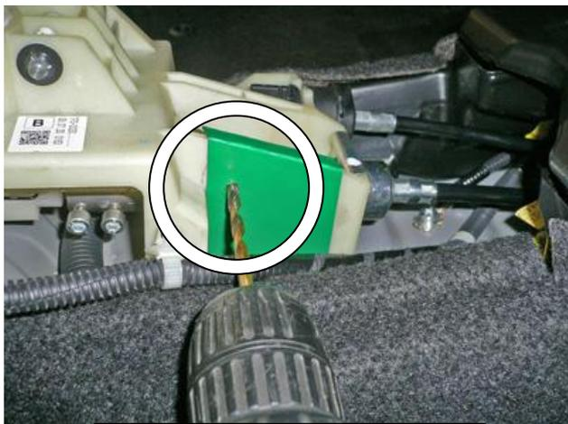
Разметить отверстие в селекторе под трубу замка
