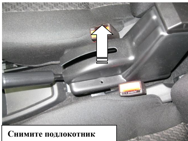
Открутите два самореза крепления подлокотника
