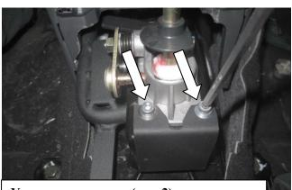
Установите защиту (поз. 2), закрепив болтами (поз. 4) с шайбами (поз. 6)
