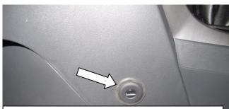
Установите шаблон SCH7 на корпус замка, разметьте и просверлите отверстие под корпус замка ф32 мм, проверьте работоспособность замка, сорвите крепеж, соберите консоль
