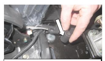
Установите замок (поз. 1), подложив под заднюю точку крепления деталь (поз. 3) и закрепив болтом (поз. 5) с шайбой (поз. 7)
