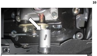
Приложите замок к селектору, отметьте место сверления под трубу замка, просверлите отверстие в стенке селектора ф22 мм.
