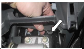
Подложите под переднюю точку крепления замка деталь (поз. 3) и закрепите болтом (поз. 5) с шайбой (поз. 7)
