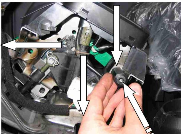
Открутить 2 штатных болта и 1 штатную гайку селектора, установить шестигранный столбик на шпильку
