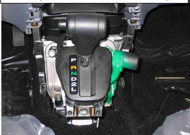
Перевести рычаг переключения передач в положение «Р», произвести и проверить блокировку
