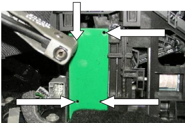
Зафиксировать пластину защиты на селекторе, используя заклёпки и клёпальник
