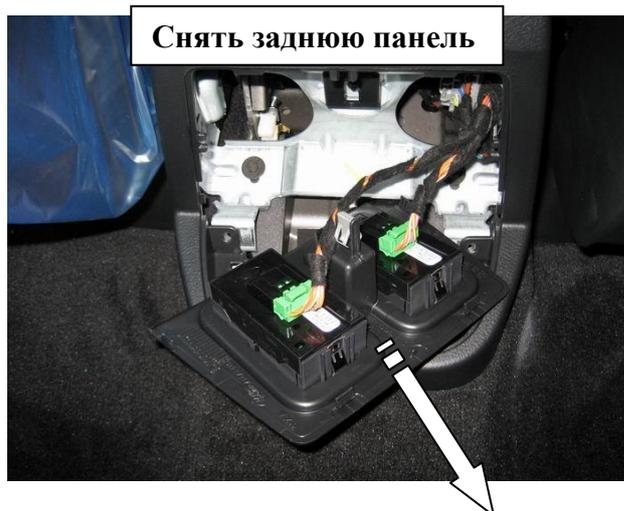
Снять заднюю панель
