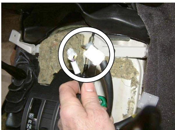
Разъединить разъёмы, снять консоль
