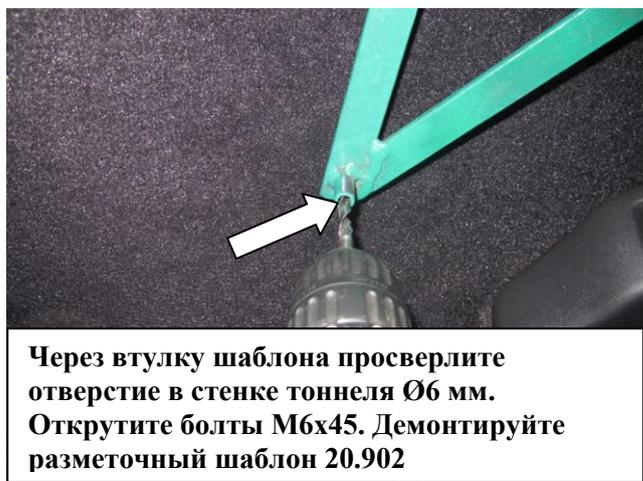
Через втулку шаблона просверлите отверстие в стенке тоннеля Ø6 мм. Открутите болты М6х45. Демонтируйте разметочный шаблон 20.902
