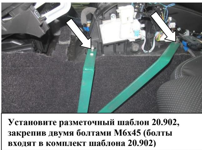
Установите разметочный шаблон 20.902, закрепив двумя болтами М6х45 (болты входят в комплект шаблона 20.902)
