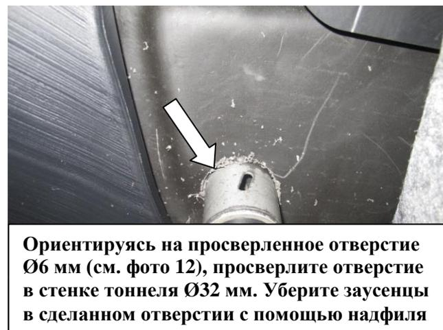
Ориентируясь на просверленное отверстие  $\varnothing 6$  мм (см. фото 12), просверлите отверстие в стенке тоннеля  $\varnothing 32$  мм. Уберите заусенцы в сделанном отверстии с помощью надфиля
