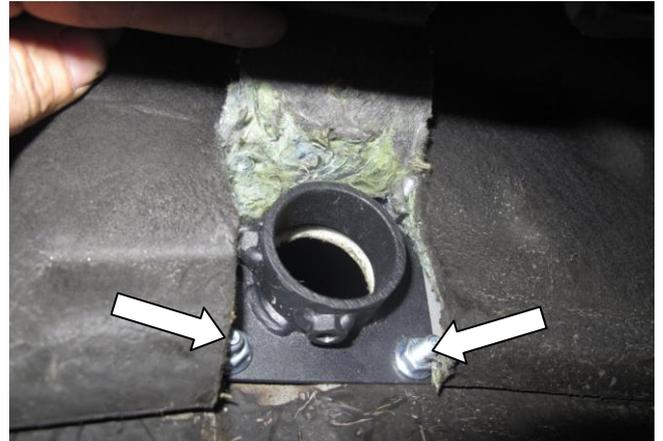
Установите кронштейн (поз. 2) из-под днища автомобиля, предварительно удалив шумоизоляцию. Закрепите кронштейн болтами (поз. 7) с шайбами (поз. 9) и гайками (поз. 8) через просверленные отверстия
