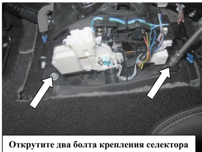
Открутите два болта крепления селектора
