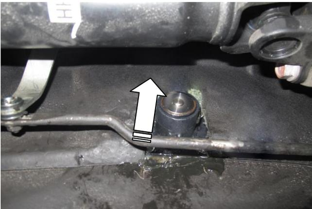
Установите замок (поз. 1) в кронштейн (поз. 2), закрепив болтами (поз. 5).
