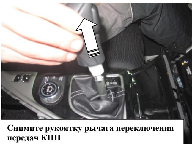
Снимите рукоятку рычага переключения передач КПП
