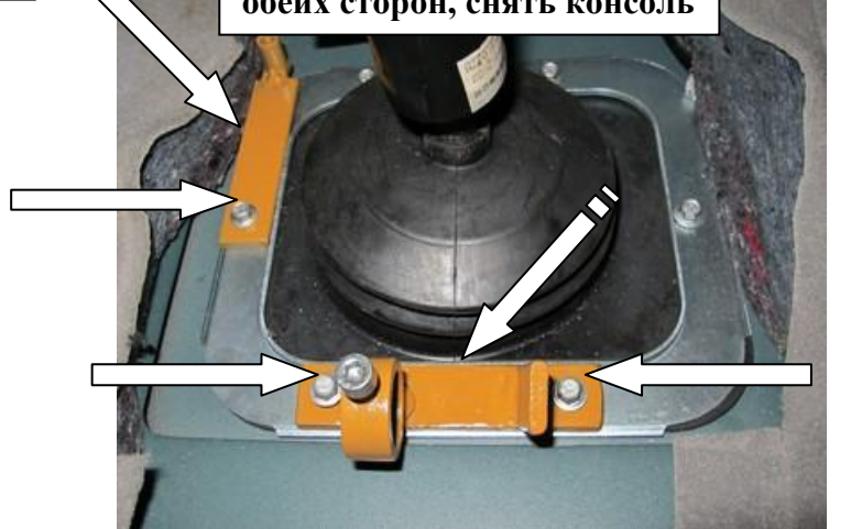
4 Установить 2 детали-переходника, зафиксировать 3 штатными болтами
