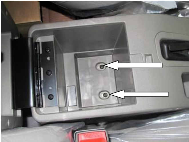
1 Поднять подлокотник, открутить 2 самореза
