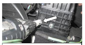
Приложите замок на посадочные места, разметьте место выхода ригеля и просверлите по разметке отверстие ф 22мм в стенке селектора
