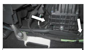
Снимите воздуховод, установите замок (поз. 1), закрепив гайками (поз. 2) с шайбами (поз. 3), установите воздуховод обратно
