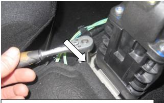
Открутите задний левый винт крепления селектора
