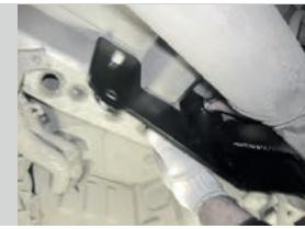
**ШАГ 3.** Установите центральный кронштейн, совместив отверстия в кронштейне центральном с отверстиями в боковых кронштейнах и соедините всё с помощью болтов M10x40x1,25, гаек M10x1,25, шайб M10 и шайб пружинных M10.
