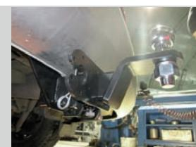
Тип соединения: шаровый; Диаметр сцепного шара: 50 мм.; Масса комплекта ТСУ 11041501: 23 кг.
