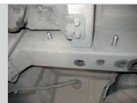
**ШАГ 2.** Установите боковые кронштейны и закрепите их с помощью гаек M12 через шайбы M12 с двух сторон лонжерона и шайбы M12 пружинные. Кронштейны не затягивайте.
